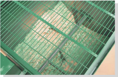
Buncăr pt. rumeguș cu grătar de cernut, amestecător și sneck pt. dozarea rumegușului în camera de uscare-ardere
